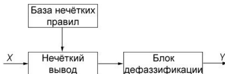
Рис. 1. Структура системы нечёткого вывода, основанной на нечёткой степени истинности Fig. 1. The structure of the fuzzy system output based on fuzzy truth degree
